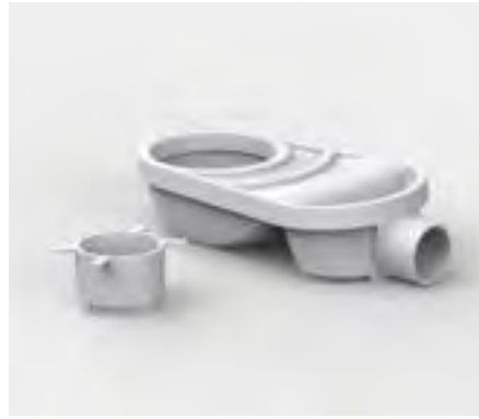
SIFÃO SIFÓNICO Sifão com 58mm de altura, com um design que proporciona uma drenagem eficiente (28 l/min), limpeza e manutenção. Este sifão que agrega um adaptador com tela selada de fábrica necessita de uma altura total de instalação de 70mm.
