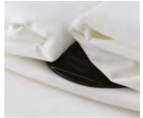
TELA TERMOSELADA A ADAPTADOR A tela geotêxtil, com 4 folhas na sua composição, duas interiores compostas por EVA e duas exteriores em tecido não tecido, permitindo uma maior impermeabilização e canalização da água através do sifão.
